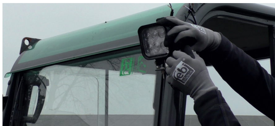
Anbringung eines Arbeitsscheinwerfers.
