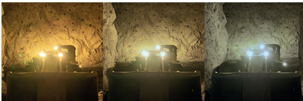
Die Farbtemperatur des RokLUME 280N Smart lässt sich stufenlos von Warmweiss auf Kaltweiss einstellen.
