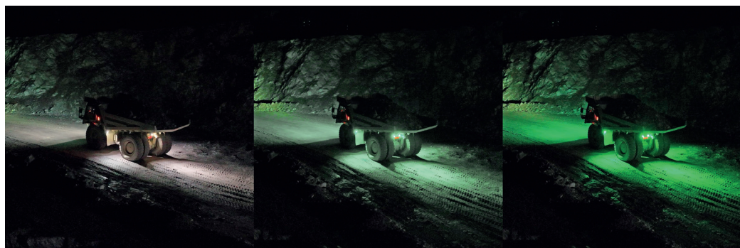
Eine grüne Lichtfarbe verbessert die Sicht bei Nebel, Regen, Schneefall und Staubentwicklung.
