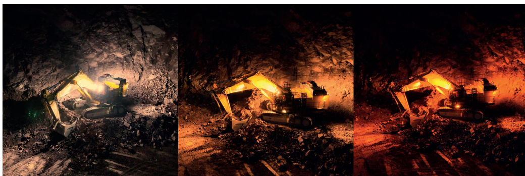
Eine orange Lichtfarbe verbessert die Sicht bei Nebel, Regen, Schneefall und Staubentwicklung.
